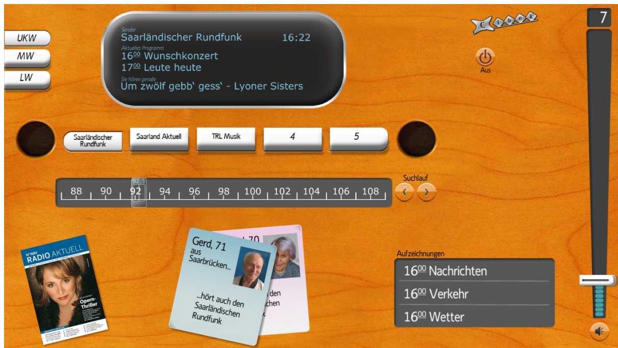
Abbildung 2: Hier wurde der Sendersucher innerhalb von 0,2s um mindestens 1 Strich, aber maximal um 3 Striche verschoben. Dadurch wurde die Aktion "Suchlauf" gestartet. Der Sucher bleibt an der Stelle stehen, an der er den ersten guten Sender gefunden hat.
